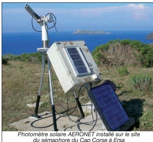
Photomètre solaire AERONET installé sur le site du sémaphore du Cap Corse à Ersa
